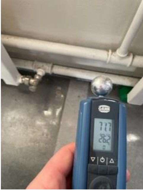
Mynd 5 Stofa 121, hækkaður raki að mælast í plötu
