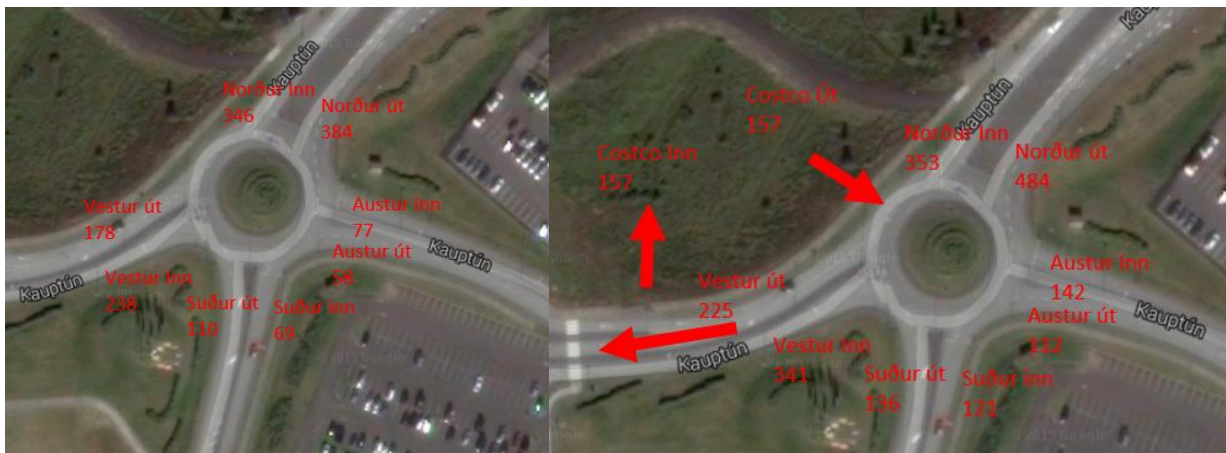
Mynd 3) Umferð á annatíma í hringtorgi Kaupþúns fyrir (vinstri) og eftir byggingu bensinstöðvar (hægri)
