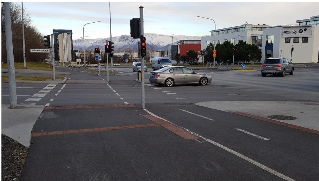
MYND 39 Ljósagatnamót með sér ljós ætluð hjólreiðamönnum og sér ljós ætluð gangandi. Háleitibraut, Reykjavík.
