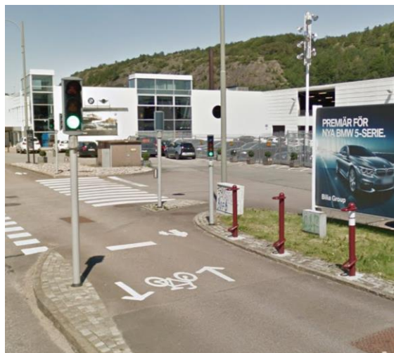
MYND 78 Fótstig við ljósastrýrð gatnamót á stofnhjólaleið í Gautaborg / Mölndal. (Mynd: Google Maps)
