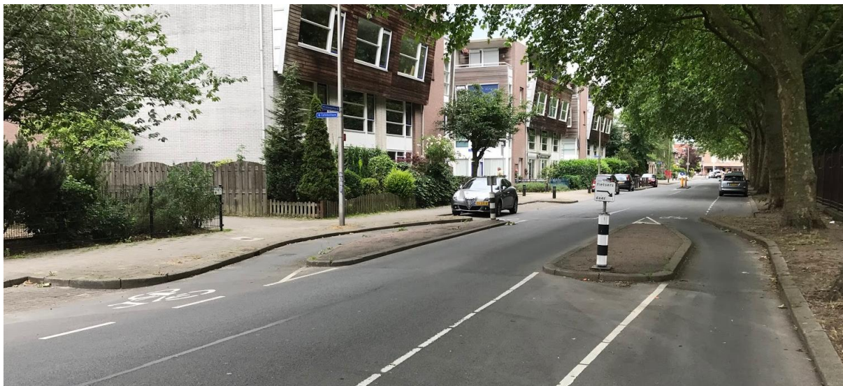
MYND 66 Hjáleið fyrir hjólandi vegfarendur framhjá þrengingu í Utrecht, Hollandi. (Mynd: Ragnar Gauti Hauksson)
