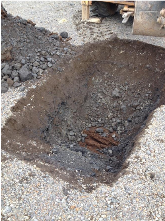
Mynd 1 Gryfja 5: Dæmigerð uppbygging á gryfju, 70cm af fyllingarefni ofan á mýrarlagi. Þetta fyllingarefni var sérlega fíngert. 0-20cm
