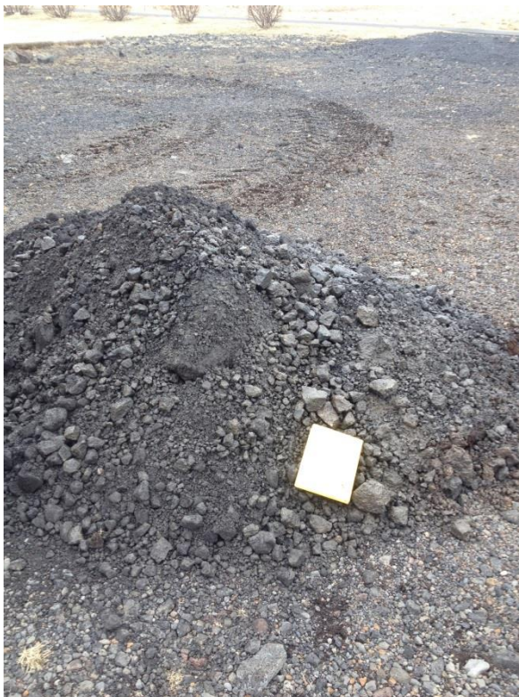
Mynd 3 Fyllingarefni frá gryfju 1, Bók í A5-broti til viðmiðunnar
