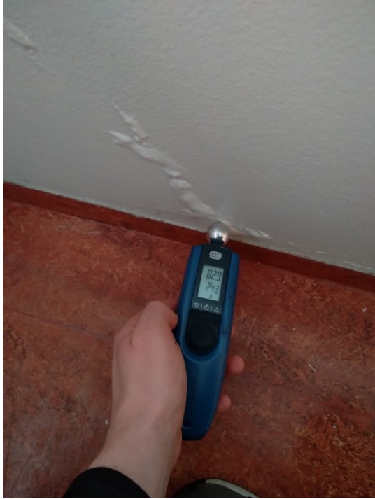
Mynd 12 Hækkaður raki í vegg
