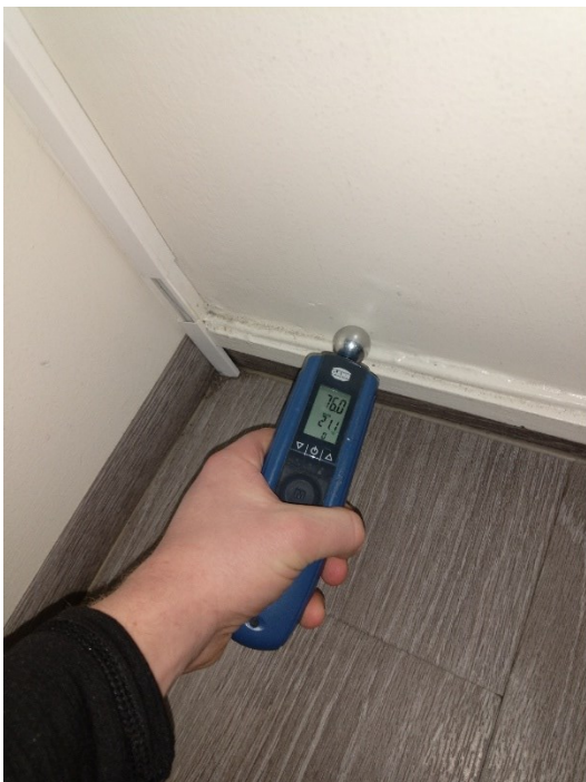
Mynd 7 Hækkaður raki á botni stofuveggs
