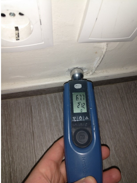
Mynd 9 Hækkaður raki á botni stofuveggs
