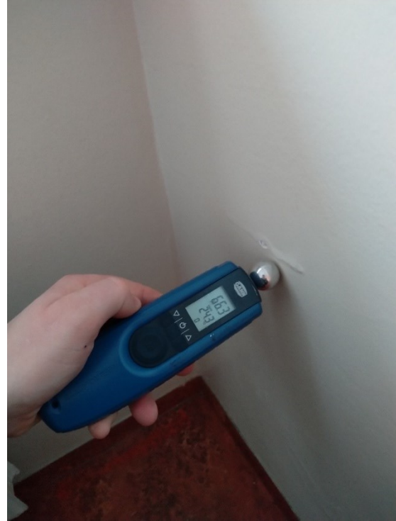
Mynd 13 Hækkaður raki í vegg
