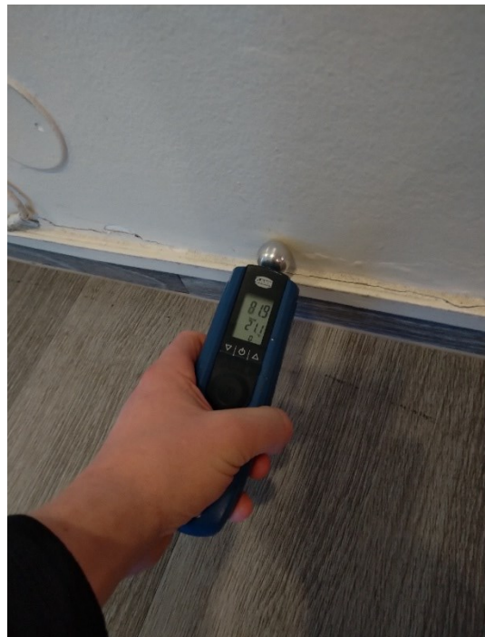
Mynd 8 Hækkaður raki á botni stofuveggs
