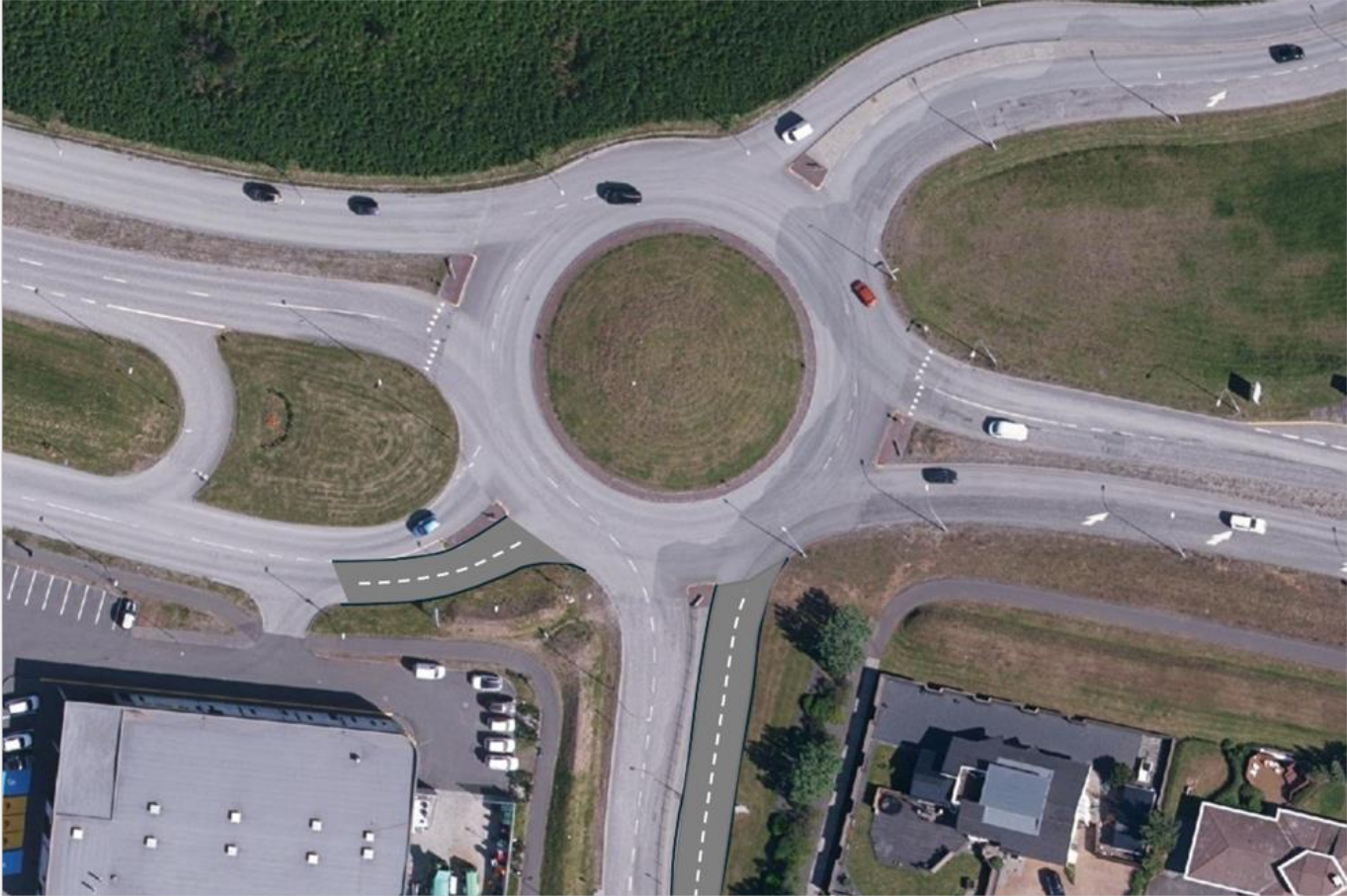
Skýringarmynd, möguleg útfærsla á hringtorgi með tvöföldum akreinum inn á hringtorg.
