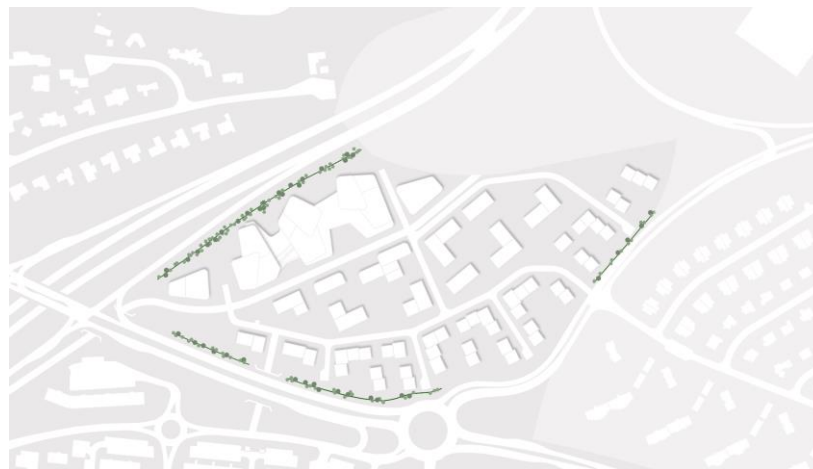
Skýringarmynd, sýnir staðsetningu hljóðvarna austan við Hafnarfjarðarveg og norðan við Arnarnesveg. Hljóðvörnum/skermun skal fléttað saman með gróðri til þess að milda ásjón þeirra.
