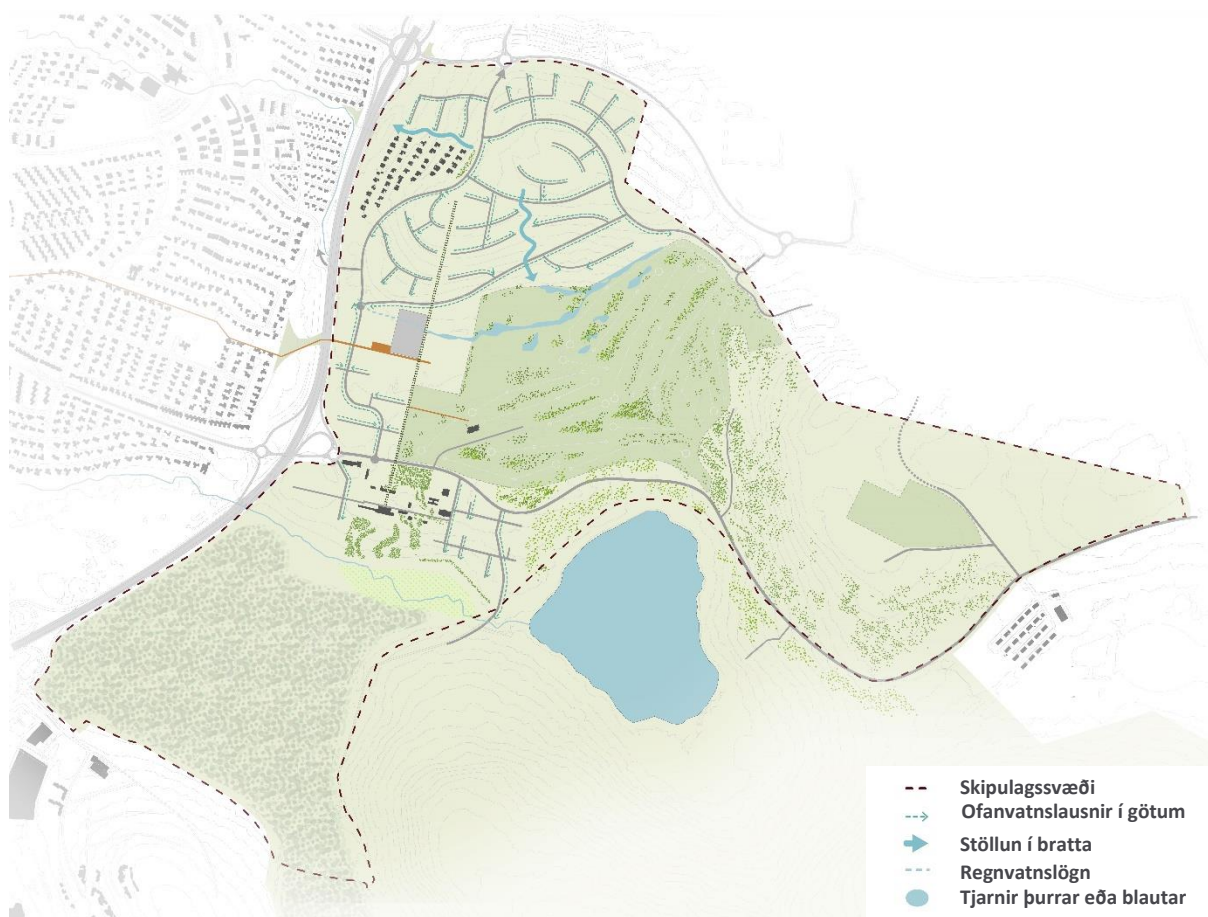
MYND 34 Ofanvatn er hreinsað með blágrænum ofanvatnslausnum áður en það rennur saman við læki í átt til sjávar. Í Hnoðraholti er ofanvatni fyrst fleytt í rásur meðfram götum, þar næst í læki sem eru stallaðir í bratta í átt að regnbeðum í Vetrarmýri og þaðan í Arnarneslæk. Við Vífilsstaði er ofanvatni fleytt í rásur í átt lækjum og þaðan í Hraunsholtslæk.
