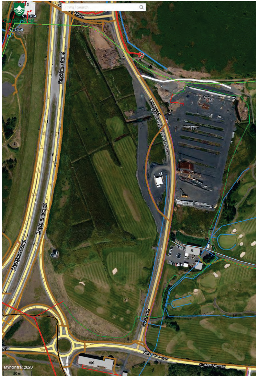
MYND 5-5 Strengir og leiðslur sem liggja að og við deiliskipulagssvæðið. Merktar eru inn leiðslur frá Orkuveitunni, lýsing gatna og stíga, fráveita, vatnsveita og leiðslur frá HS Veitum (skjáskot frá map.is/gardabaer).
